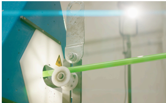
Das ÖKO-FLEX Flächenheizrohr befindet sich am Förderantrieb auf dem Weg zum nächsten Produktionsschritt.
