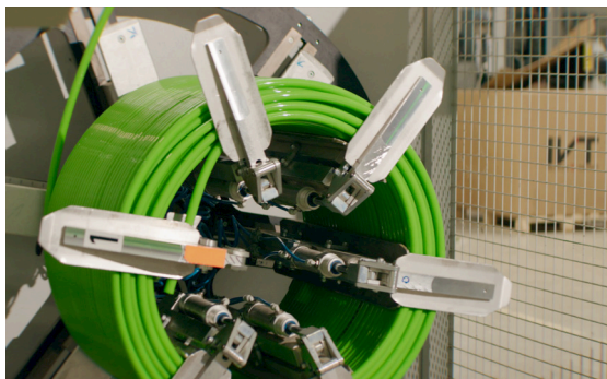
Die Ringbunde des Rohres werden am vollautomatischen Doppelwickler nach Längenvorgabe aufgewickelt und anschließend für die Verpackung vorbereitet.
